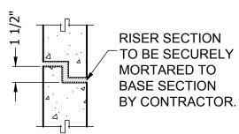
WALL JOINT DETAIL (WHEN REQUIRED)
