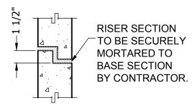
WALL JOINT DETAIL (WHEN REQUIRED)
