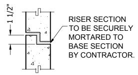
WALL JOINT DETAIL (WHEN REQUIRED)
